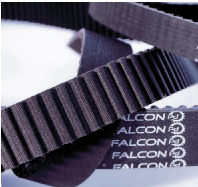
Die Riemenzähne und der Riemenrücken bestehen aus einem weiter verbesserten HNBR-Hochleistungs-Elastomer mit hervorragender Beständigkeit gegenüber Öl- und Schmierstoffen sowie Chemikalien. Die Riemen können im Temperaturbereich von -50°C bis +105°C ohne Leistungseinbußen eingesetzt werden.
