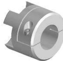
Klemmnabenausführung, doppel geschlitzt ohne Paßfedernut. Ab Baugröße 24/28. Spielfreie Nabe, übertragbares Moment abhängig vom Bohrungsdurchmesser.
