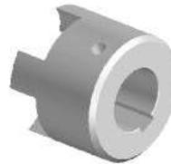
Nabe mit Fertigbohrung, Paßfedernut und Stellschraube. Nicht geeignet für spielfreie Antriebe mit häufigem Drehrichtungswechsel oder häufiger Anlaufbelastung.
