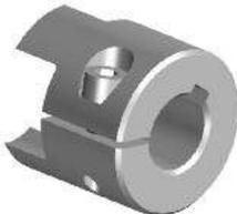
Klemmnabenausführung, einfach geschlitzt mit Paßfedernut. Bis Baugröße 19/24. Die Klemmung verhindert Spiel bei Lastumkehr.
