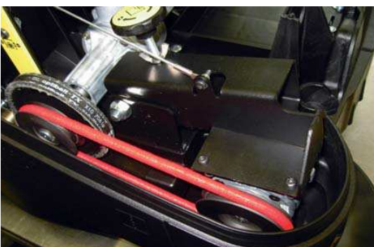
Bezkońcowe, elastyczne pasy okrągłe, czerwone PU, w przegrodzie silnikowej maszyny czyszczącej
