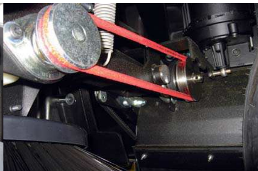
Boczny napęd szczotki w zamiatarce mechanicznej
